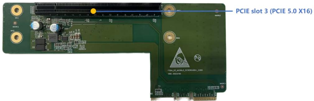
Riser 卡 3（2\*PCIE X16 物理插槽）
