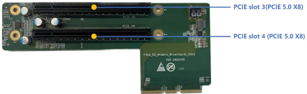
Riser 卡 2（1\*PCIE X16 物理插槽）
