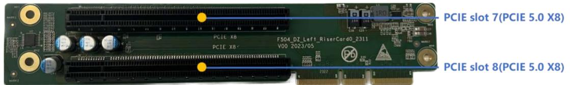
Riser 卡 4（1\*PCIE X16 物理插槽）
