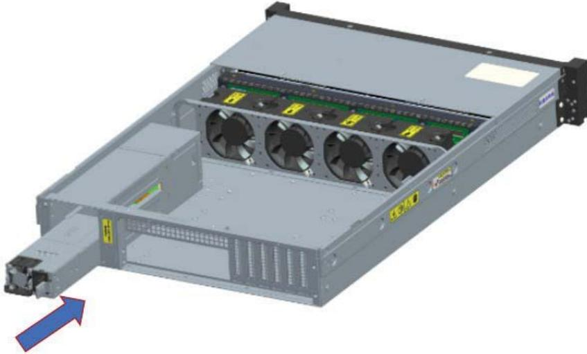
分别插入热插拔电源模块 PSU1 和 PSU2。
