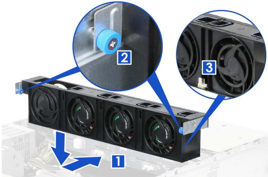
风扇组件安装
